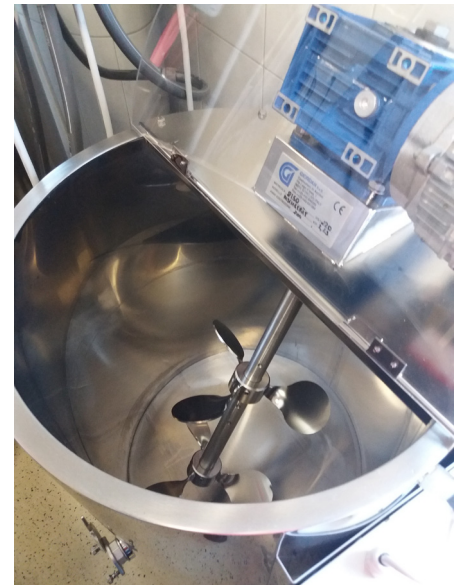
Abb. 10 - Sehr gute Lösung: Ein Rührwerk für kleine bis mittlere Imkereien. So erspart man sich das Rühren mit der Bohrmaschine, das immer die Gefahr mit sich bringt, dass Schmutz in den Honig gelangt.
